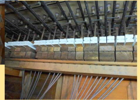
Übergang von der pneumatischen Spieltraktur auf eine mechanische Kegellade mittels Keilbälgen
