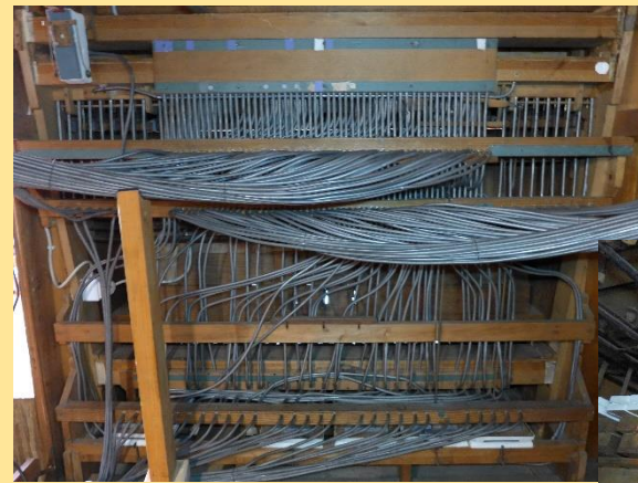
Anschluß des Spieltisches an die Pneumatik (Bleiröhrchen)
